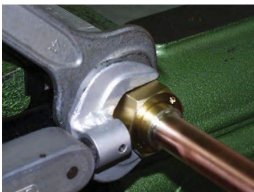
11. 根据扭矩表，来设定力矩对夹紧螺母进行紧固
