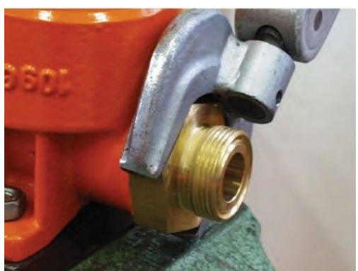
12. 螺纹装的接头带有 O 圈或铜封被封进体室或罩内。
