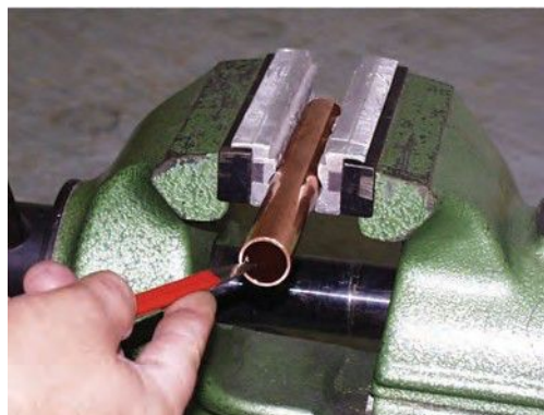
2. 管道里外及末端的修边去刺
