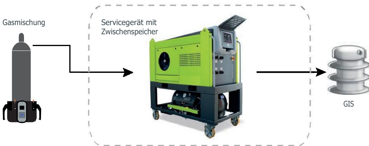
图3: 带有缓冲罐的回收装置将部分液化的混合物从被加热的容器转移的操作原理示意图.
