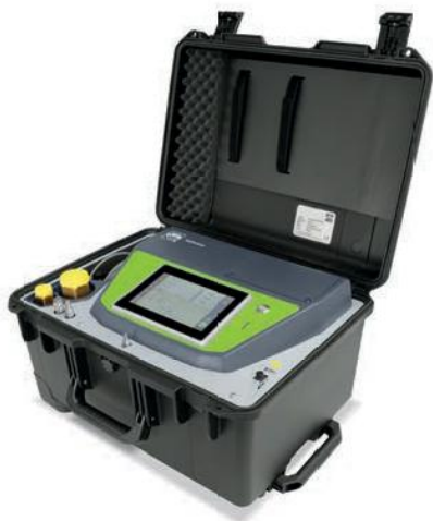
图1:多功能分析仪用于测量浓度 C4-FN或者 C5-FK, 氧气(O 2 ), 湿度(使用电,露点传感器), 二氧化碳(CO 2 ) 和一氧化碳(CO).
